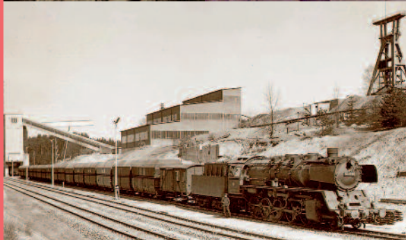
Mitte links: Kumpel untertage 1951; Mitte rechts: Hauer und Schlepper beim Abbau unter Tage um 1960; unten: Beladener Eisenerzzug vor Konzentratbunker, Aufbereitungsanlage und Förderturm zu Schacht I um 1960
